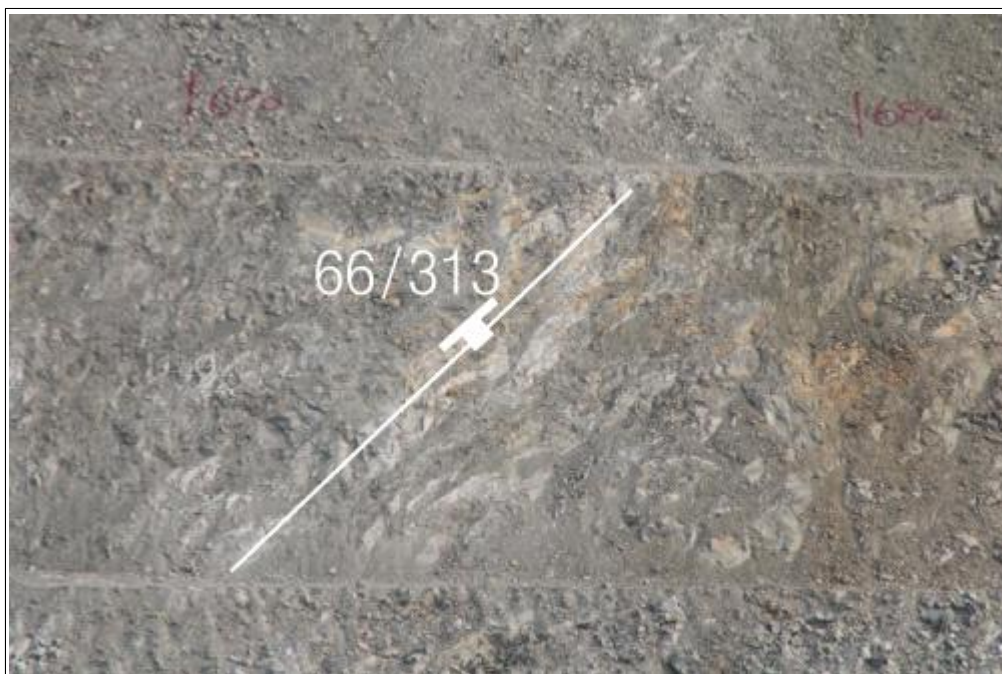
【그림 19】 C 영역에 발달한 불연속면
