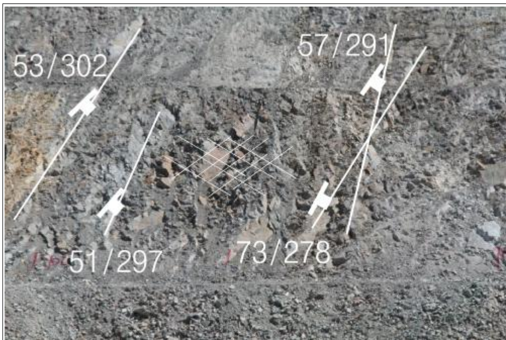
【그림 14】 B 영역에 발달한 불연속면
