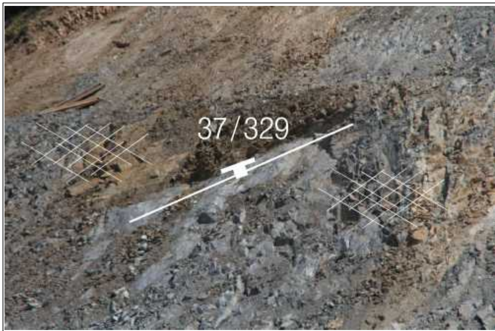
【그림 11】 A 영역에 발달한 불연속면
