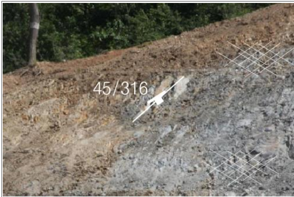
【그림 12】 A 영역에 발달한 불연속면
