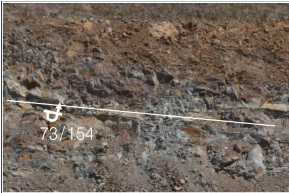
【그림 31】 F 영역에 발달한 불연속면
