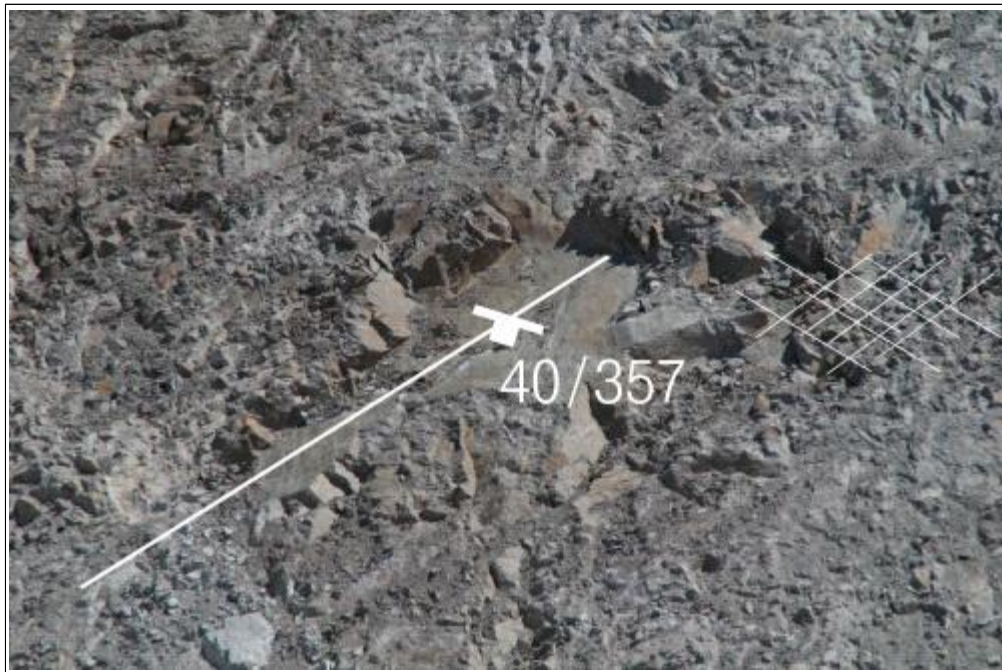
【그림 15】 B 영역에 발달한 불연속면
